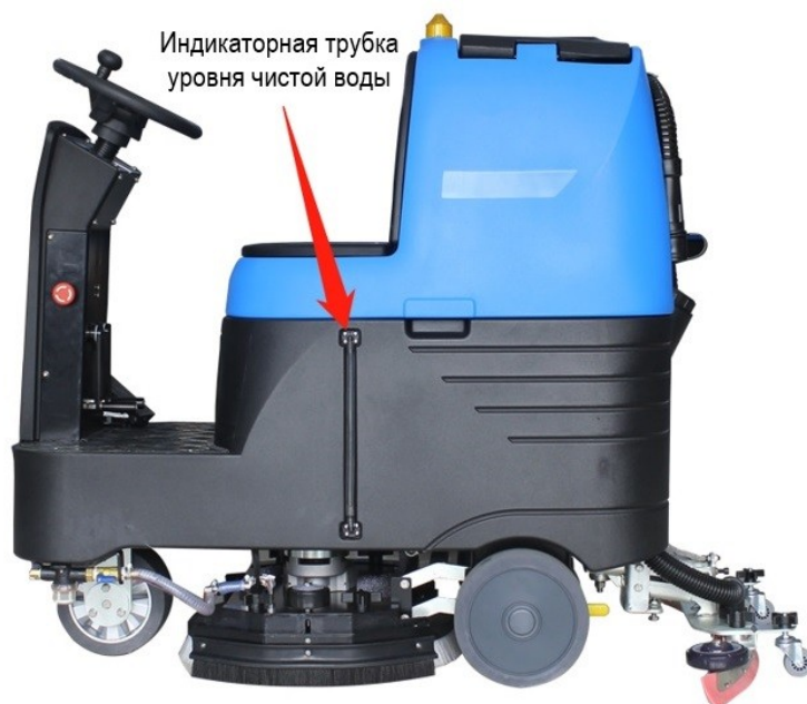
Прозрачная трубка для контроля уровня воды в баке
