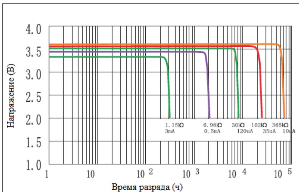
Зависимость напряжения на элементе питания от тока разряда и температуры
