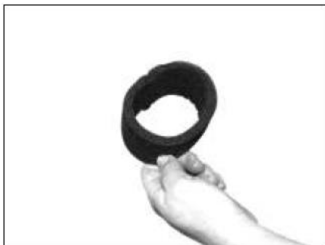
5) Осторожно выбить фильтр грубой очистки или очистить сжатым воздухом.
