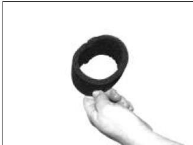
6) Осторожно выбить фильтр грубой очистки или очистить сжатым воздухом
