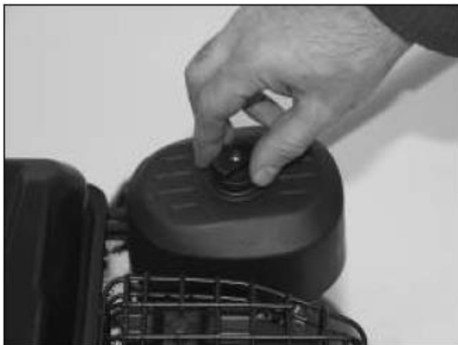
1) Ослабить болт крышки воздушного фильтра
