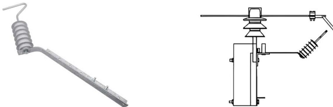
*Рис. 1. Внешний вид устройств защиты от дуги*
