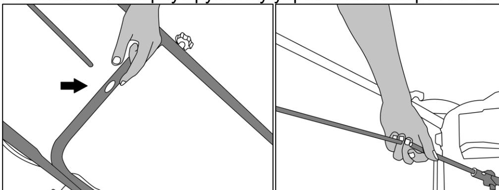
Рис. 3. Установка рукоятки
