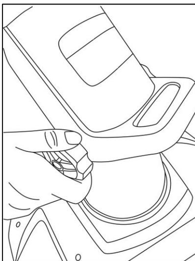
Рис. 6 Установка отражателя
