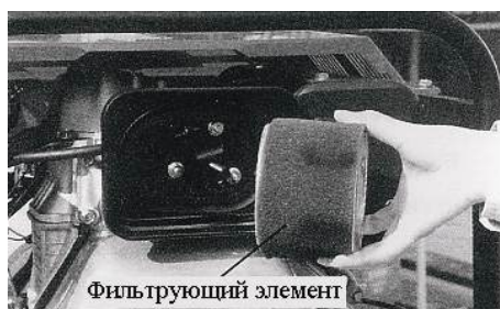
Рис.12. Обслуживание воздушного фильтра
