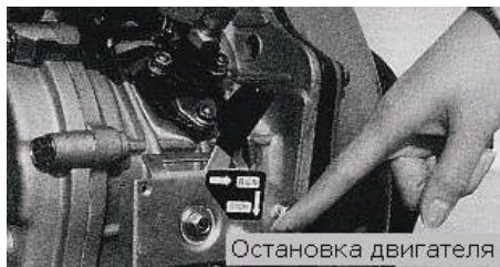
Рис. 9. Рычажный механизм управления двигателем
