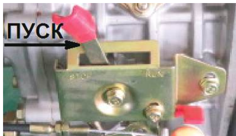
Рис. 6. Рычажный механизм управления двигателем
