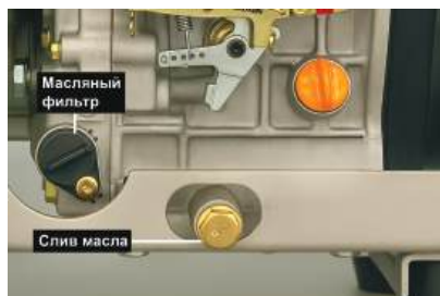
Рис.11. Очистка масляного фильтра
