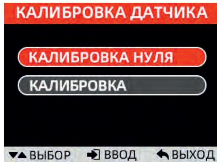
б. Установите вес. Нажмите «Калибровка», чтобы начать процесс калибровки.
