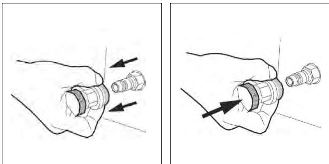
Сервисные бысторазъемные соединения подключаются к сервисным разъемам системы кондиционирования автомобиля во время обслуживания кондиционера. Когда машина не используется, к машине можно подсоединить сервисные бысторазъемные соединения.
