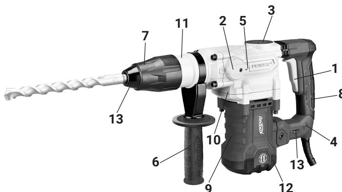
1) клавиша выключателя; 2) переключатель режимов “сверление с ударом”/“удар”/“разблокировка ствола”; 3) крышка смазочного окна; 4) индикатор сети; 5) фиксатор переключателя режимов; 6) дополнительная рукоятка; 7) патрон SDS-max; 8) рукоятка; 9) корпус двигателя; 10) корпус редуктора; 11) корпус ствола; 12) крышка двигателя; 13) регулировка скорости (частоты вращения)
