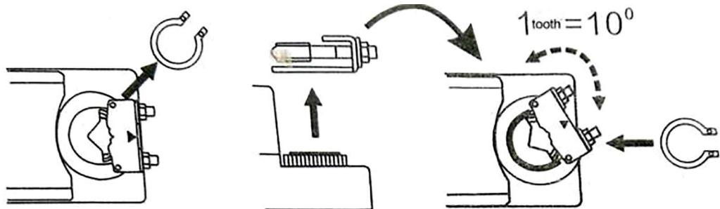
А: Механическая регулировка предела (для снятия стопорного кольца используйте плоскогубцы)
