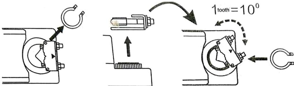
A: Механическая регулировка предела (для снятия стопорного кольца используйте плоскогубцы)
