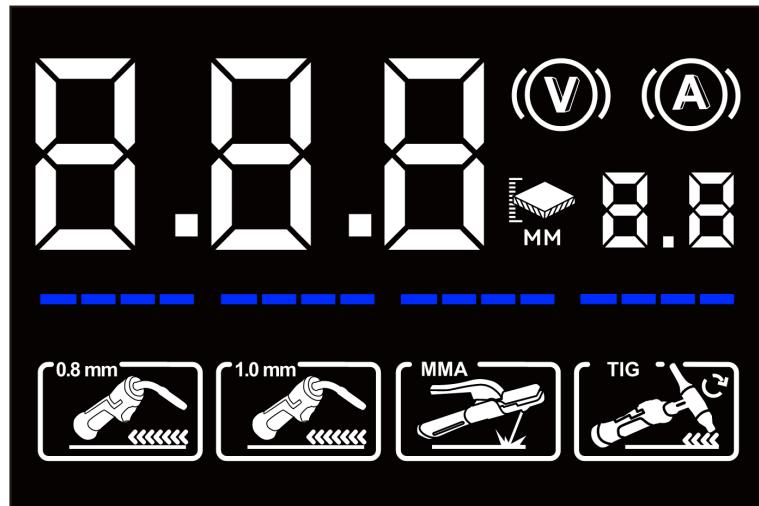
В главном меню отображаются иконки определенных параметров для каждого режима сварки. Эти иконки представляют различные настраиваемые параметры. Для более четкого понимания настроек см. "Справочную таблицу режимов сварки и иконок параметров". Эта таблица поможет сварщику быстро определить и настроить параметры для каждого режима сварки.
