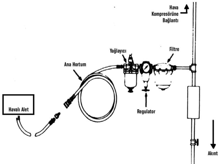
Для эффективного использования инструмента подключение кондиционера можно выполнить, как показано на рисунке. Если кондиционер не используется, в воздушную систему можно капнуть 1-2 капли машинного масла. Вы можете сделать это в любой момент использования. Не следует превышать значения давления воздуха на изделии (90 фунтов на квадратный дюйм / 6,2 бар). Держите подачу воздуха выключенной, когда вы не работаете.
