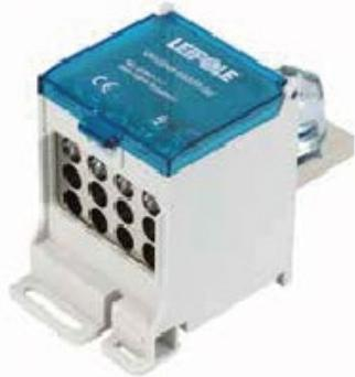
Клемма переключения, один вход, двенадцать выходов, латунь H59, никелированное покрытие, IP20, UL94 V-0
