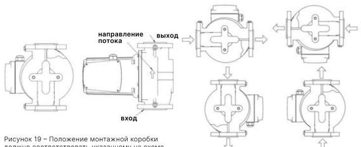
Рисунок 19 – Положение монтажной коробки должно соответствовать указанному на схеме, а также соблюдены вход и выход насоса, согласно направлению потока
