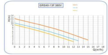
Рисунок 3 – Технические характеристики для серии 40-13F-380V
