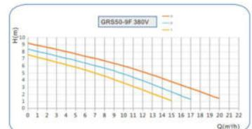
Рисунок 9 – Технические характеристики для серии 50-9F-380V
