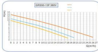
Рисунок 11 – Технические характеристики для серии 50-13F-380V
