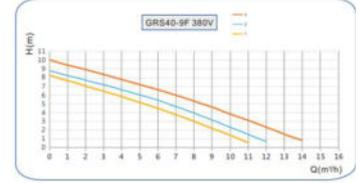
Рисунок 5 – Технические характеристики для серии 40-9F-380V
