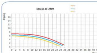
Рисунок 16 – Технические характеристики для серии 65-6F-220V
