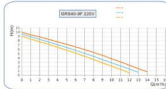
Рисунок 4 – Технические характеристики для серии 40-9F-220V
