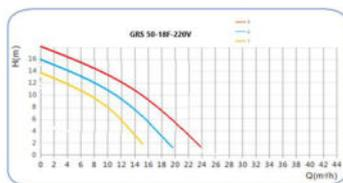
Рисунок 15 – Технические характеристики для серии 50-18F-220V
