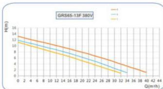
Рисунок 12 – Технические характеристики для серии 65-13F-380V
