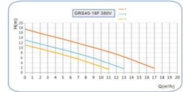
Рисунок 7 – Технические характеристики для серии 40-18F-380V
