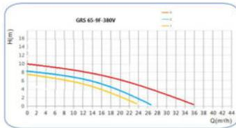
Рисунок 18 – Технические характеристики для серии 65-9F-380V
