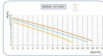
Рисунок 2 – Технические характеристики для серии 40-13F-220V
