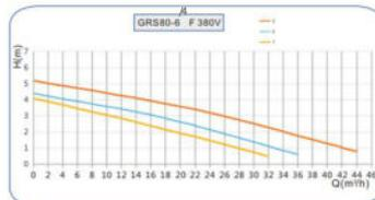
Рисунок 13 – Технические характеристики для серии 80-6/4F-380V
