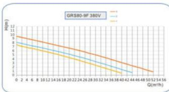
Рисунок 14 – Технические характеристики для серии 80-9F-380V
