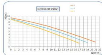
Рисунок 8 – Технические характеристики для серии 50-9F-220V
