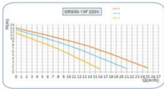
Рисунок 10 – Технические характеристики для серии 50-13F-220V
