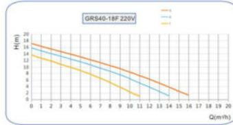
Рисунок 6 – Технические характеристики для серии 40-18F-220V
