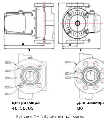
Рисунок 1 – Габаритные размеры
