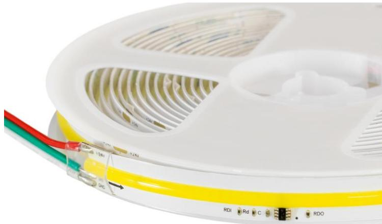
Светодиодная лента ELFLED представляет собой шлейф из СОВ диодов, плотно расположенных на тонкой, гибкой плате длиной 5000 мм и шириной всего 10 мм, количество СОВ светодиодов в метре – 480 шт. Расстояние между точками реза составляет – 100 мм. Удобство монтажа обеспечивается клейкой 3М основой на обратной стороне светодиодной ленты.
