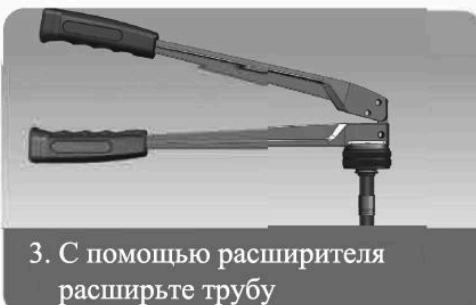
3. С помощью расширителя расширьте трубу
