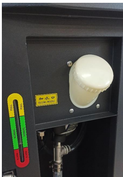
Фото 6.0.3. Заливание охлаждающей жидкости.
