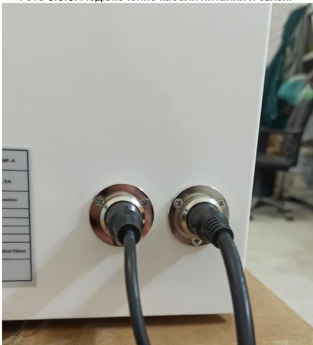
Фото 6.0.6. Подключение кабеля питания и связи.
