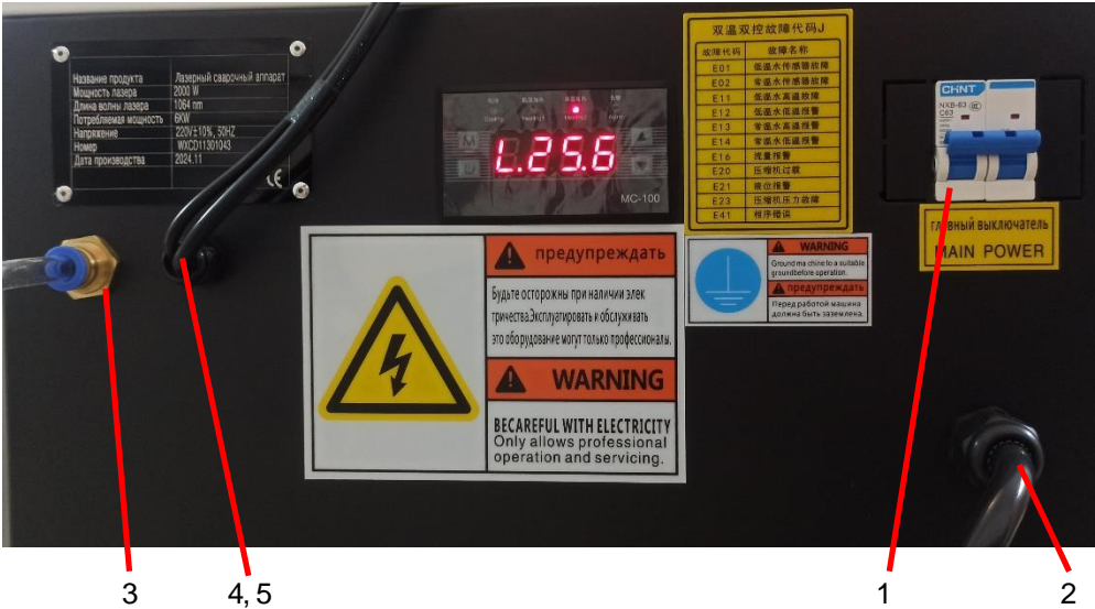
Фото 6.0.1. Расположение разъёмов на задней панели аппарата.
