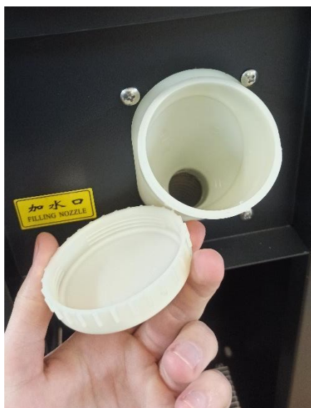
Фото 6.0.3. Заливание охлаждающей жидкости.
