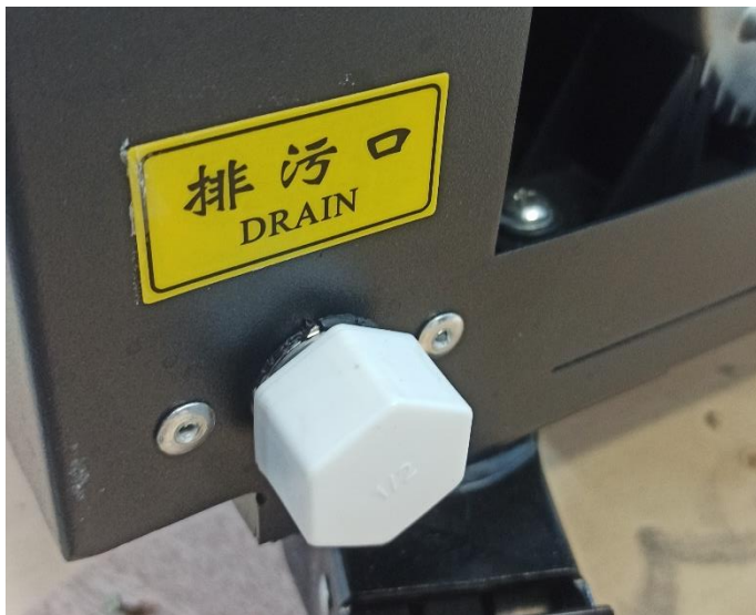
Фото 6.0.4. Слив охлаждающей жидкости.
