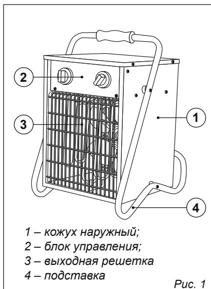
Несущая конструкция тепловентилятора состоит из кожухов наружного (1) и внутреннего, изготовленных из листовой стали.
