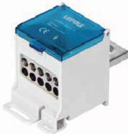
Клемма переключения, один вход, десять выходов, латунь H59, никелированное покрытие, IP20, UL94 V-0
