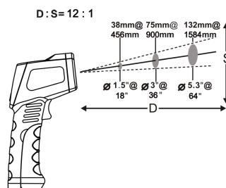
3. Поле зрения шире, чем размер пятна устройства. Чем меньше цель, тем ближе измерительное расстояние. Когда точность критична, убедитесь, что цель по крайней мере в два раза больше, чем размер пятна.
