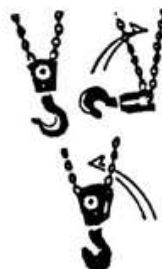
Рис.6 - Неправильное положение крюка
