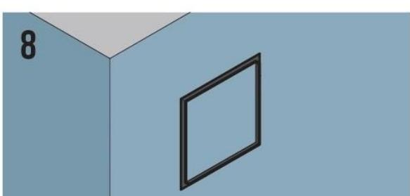
Установите лицевую панель на неодимовые магниты в монтажную рамку. Для регулировки лицевой панели вровень со стеной, используйте лапки на корпусе решетки.
