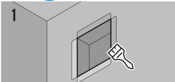
Отфрезеруйте гипокартон под монтажную рамку и загрунтуйте отфрезерованную поверхность
