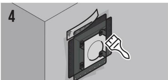
Загрунтуйте поверхность монтажной рамки, затем поверх наложите малярную ленту.
