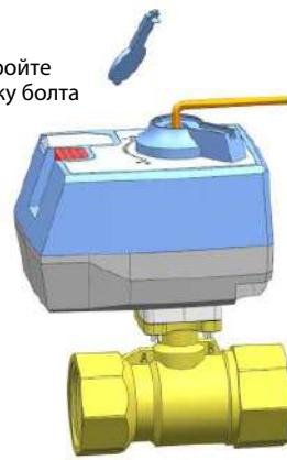
3. Вручную переведите корпус клапана в закрытое положение, совместите установочные отверстия и установите привод вертикально на корпус клапана, как показано стрелкой.
