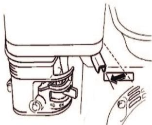
Плавно потяните за ручку стартера. Тяните до тех пор, пока двигатель не заведется
