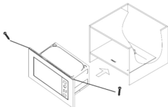
3. Откройте микроволновую печь и установите винт M4X35, вкрутив его в секцию, затем
