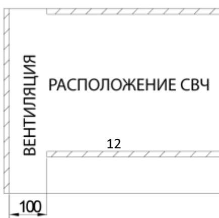
2. Поместите микроволновую печь в шкаф и закрепите двумя шурупами (M3x22мм) делая края рамы и края секции плотно выровненными.
