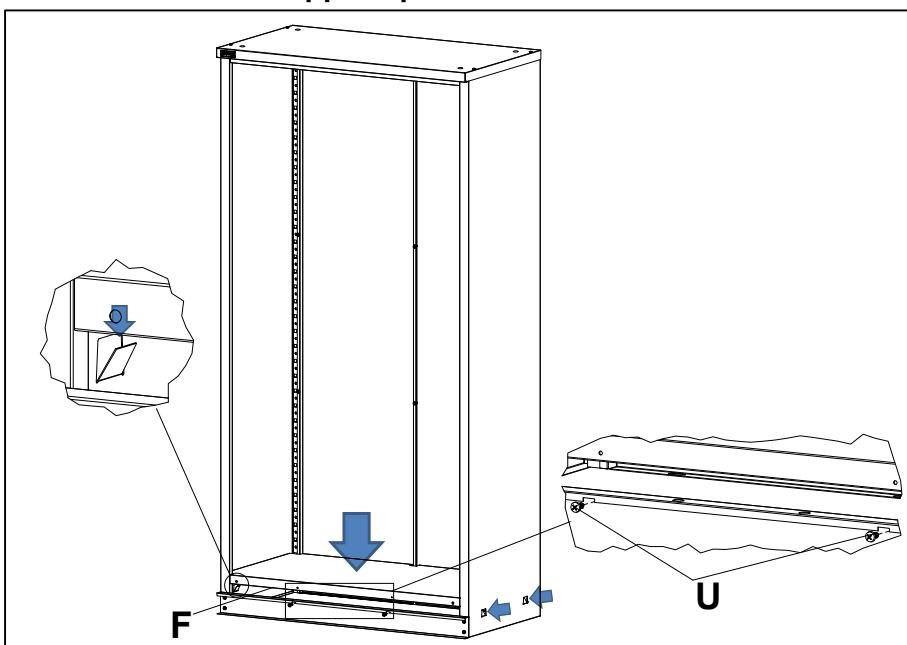
Завести днище **F** в отогнутые зацепы. Затем зафиксировать его на панели крепёжной при помощи саморезов **U** (5,5x16).
