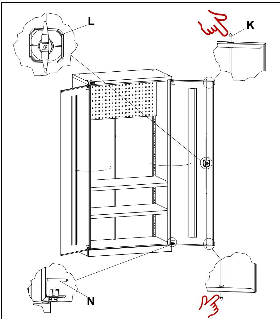
Установить замок **L** и тяги **K** на дверь, зафиксировав тяги на замке в положении "закрыто".
