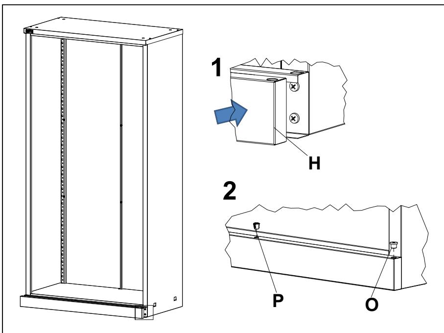
Установить панель нижнюю **H** на панель крепёжную, а затем установить на неё втулки **O** и фиксаторы направляющей **P**.
