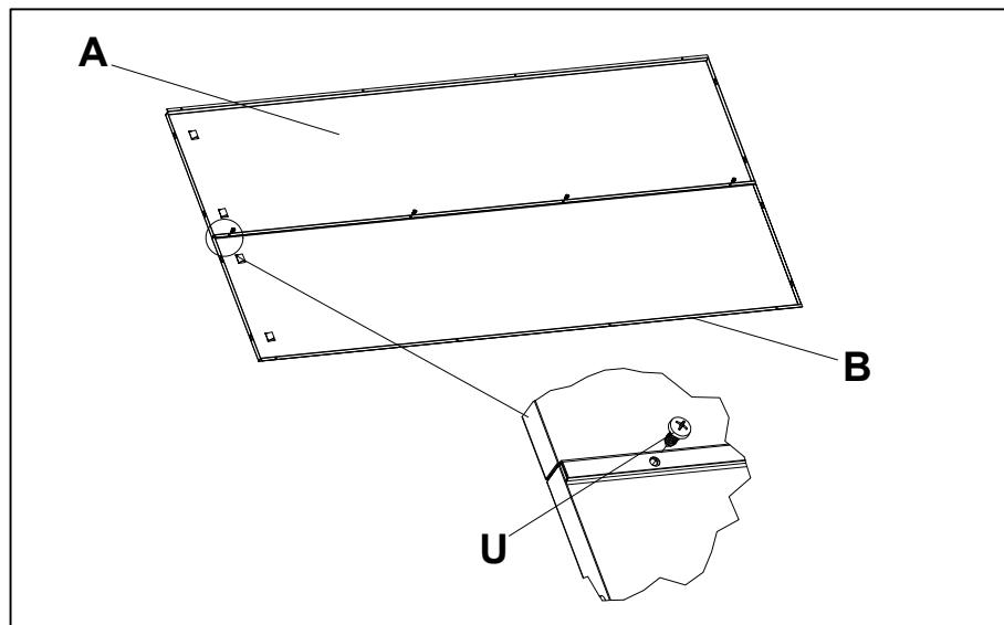
Соединить стенки задние **A**, **B** при помощи саморезов **U** (5,5x16).
