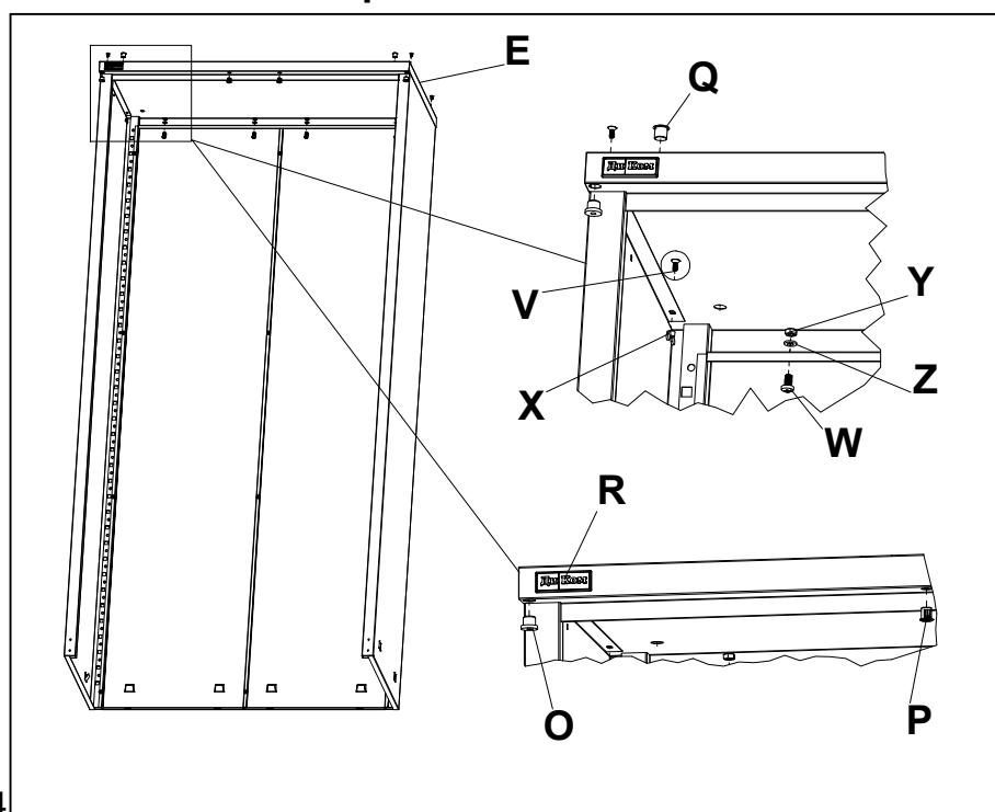
Установить крышку **E** при помощи винтов **V** (M4x10) и гаек **X**, а также винтов **W** (M6x12), шайб **Z** и гаек **Y**. Вставить в отверстия в крышке втулки **O**, фиксаторы направляющей **P**, заглушки **Q** и лейбл "ДиКом" **R**.
