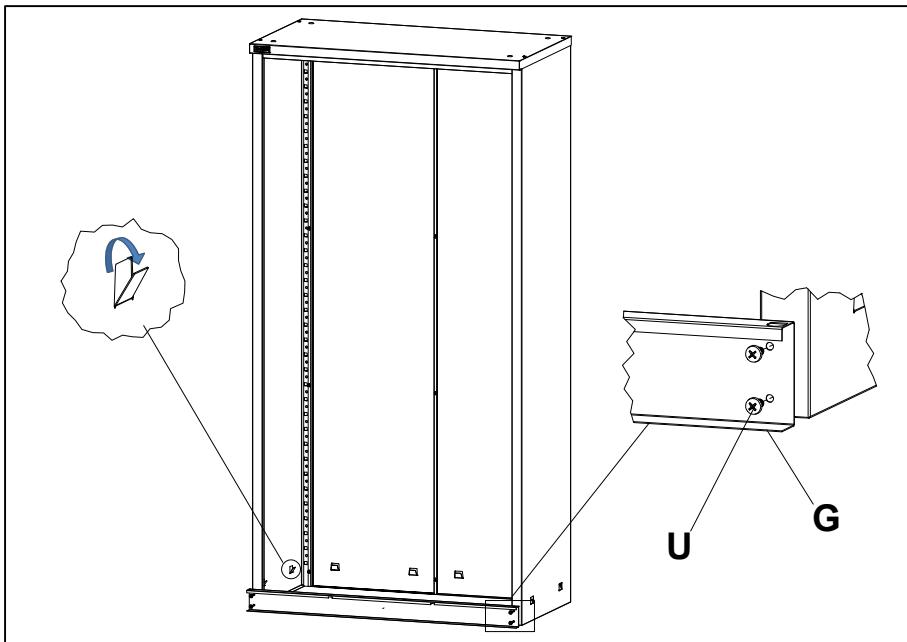
Установить панель крепёжную **G** при помощи саморезов **U** (5,5x16). Отогнуть внутрь зацепы на боковых и задних стенках.
