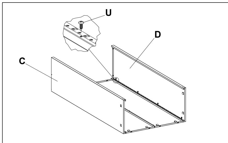
Установить стенки боковые **C**, **D** при помощи саморезов **U** (5,5x16).
