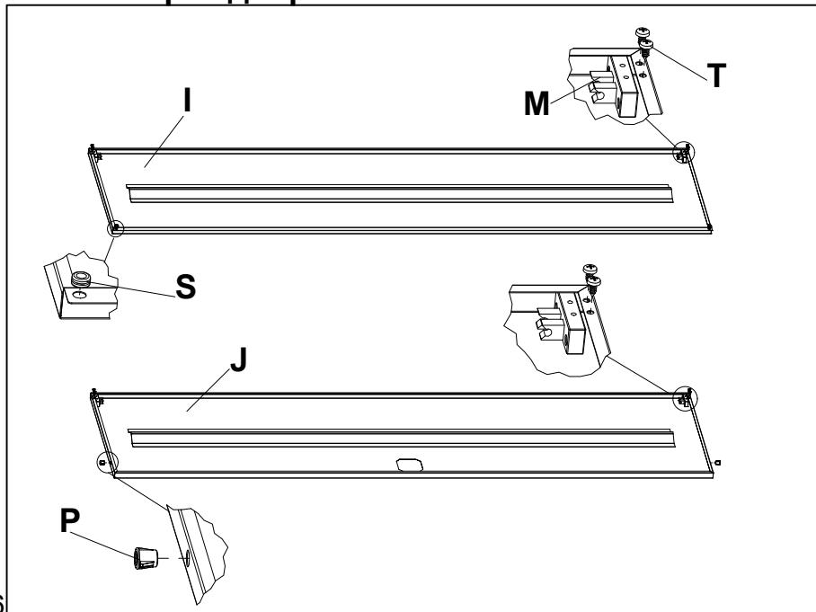
Установить петли пластиковые **M** на двери при помощи саморезов **T** (4,2x9,5). На дверь левую **I** установить упоры резиновые двусторонние **S**, а на дверь правую **J** - фиксаторы направляющей **P**.
