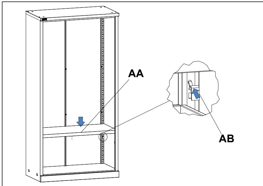
Завести опоры **AB** в круглые отверстия на боковинах. Установить полку **AA** на опоры.
