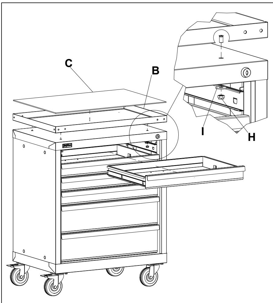
Для установки лотка **B** необходимо вынуть верхний ящик тумбы. Затем прикрепить на крышку тумбы лоток при помощи шайб **I** и гаек самоконтрящихся **H**. Вложить в лоток коврик резиновый **C**.
