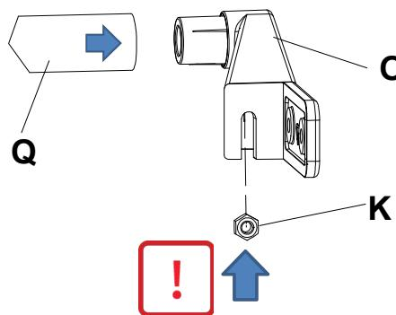
Вставить ручку левую **O** и ручку правую **P** в трубу **Q**. Завести гайки **K** внутрь пластиковых ручек. Затем установить ручки на лоток при помощи винтов **J** (M6x16), шайб **L** и гаек **K**.
