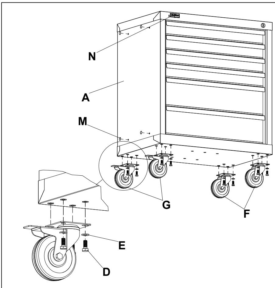
Установить на тумбу инструментальную **A** колёса поворотные **F** и колёса поворотные с тормозом **G** при помощи болтов **D** (M8x18) и шайб **E**. Установить лейблы **N** на крышку тумбы, а также стикеры **M** на отверстия на боковых стенках.
