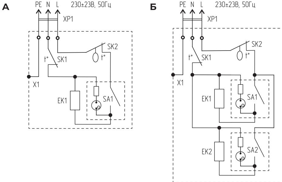
(А – GECS-1 МТ, Б – GECS-1,5 МТ, GECS-2 МТ, GECS-2,5 МТ)
