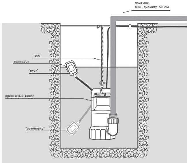
Насос оснащен поплавковым выключателем, который уже отрегулирован на определенный уровень включения и выключения насоса. Удостоверьтесь, что при минимальном уровне воды выключатель отключает насос.
