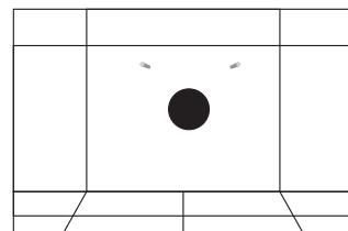
8. После завершения облицовки стены снимите внешнюю сливную трубу и резиновую защиту со шпилек.
