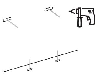
5. Уберите раму и просверлите электродрелью отверстия в отмеченных местах, затем вставьте дюбеля.
