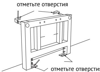
4. Установите раму в положение для монтажа и отметьте на стене и полу отверстия для крепежа.
