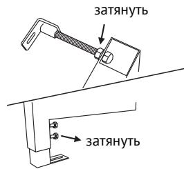
3. Отрегулируйте положение рамы с помощью уровня, затем затяните крепеж в верхней части и винты регулировочных ножек с помощью инструмента.
