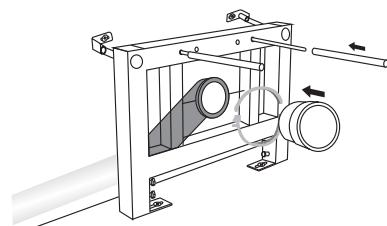
7. Подведите канализационную трубу и соедините с внешней сливной трубой, затем наденьте резиновую защиту на шпильки для установки унитаза.
