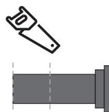
2. Обрежьте сливную трубу и обработайте край напильником.
