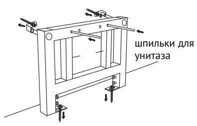
6. Верните крепежную раму в положение для монтажа и закрепите винтами к полу и стене. Установите шпильки для монтажа унитаза.
