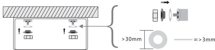
6. Наденьте защитные кольца из ПВХ на монтажные отверстия унитаза и установите чашу на шпильки, затем установите железную шайбу и фиксирующее резиновое кольцо, а затем затяните гайку.
