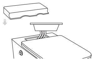
7. Установите элементы питания, блок управления сливом и заднюю крышку.
