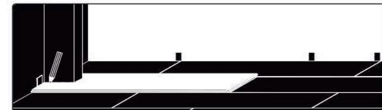
**05** При укладке тупых углов, вокруг углов или сложных профилей отметить форму на доске и вырезать по контуру с помощью пилы. После установки пола удалить распорки; подмети пол мягкой щеткой. Установить плинтуса и закрыть расширительные зазоры порожками, либо мягким силиконовым герметиком на не отвердевающей основе. Крепить плинтуса следует только к стене, но не к полу.
