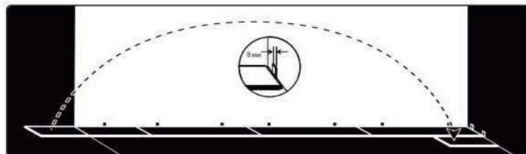
**03** С помощью ножа и угольника отрезать последнюю доску ряда такого размера, чтобы между концом ряда и стеной остался 8 мм зазор. Укладка очередного ряда начинается с остатка плитки предыдущего ряда, при условии, что длина оставшегося фрагмента не менее 1/3 и не более 2/3 длины
