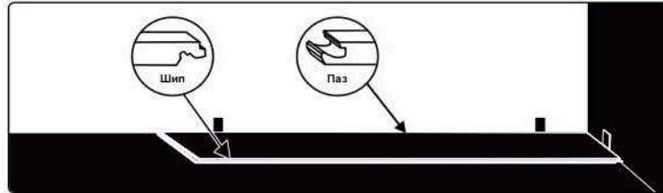
**01** Укладка плитки осуществляется последовательно в выбранном направлении. Обычно начинают с правого угла, если стоять лицом к выбранной стене. Такой способ укладки называется «шип-в-паз»
