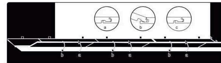
2. Собрать полоску из плиток соединив торцевые замки плиток, а затем совместить замок по длинной стороне плиток. Пробуйте и выбирайте. При сборке каждого ряда не забывайте о расширительных зазорах в 8 мм используя клинь.
