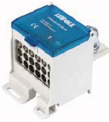
Клемма переключения, один вход, восемнадцать выходов, латунь H59, никелированное покрытие, IP20, UL94 V-0
