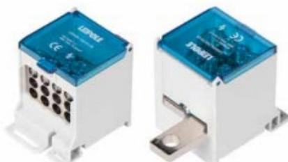
Клемма переключения, один вход, двенадцать выходов, латунь H59, никелированное покрытие, IP20, UL94 V-0
