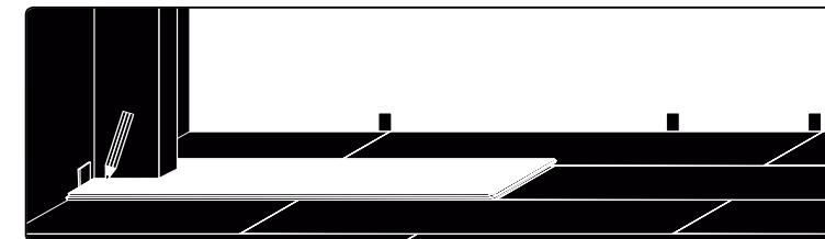
**05** При укладке тупых углов, вокруг углов или сложных профилей отметить форму на доске и вырезать по контуру с помощью пилы. После установки пола удалить распорки; поднести пол мягкой щеткой. Установить плинтуса и закрыть расширительные зазоры порожками, либо мягким силиконовым герметиком на не отвердевающей основе. Крепить плинтуса следует только к стене, но не к полу.
