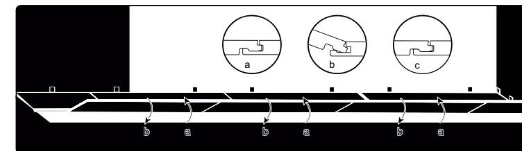
2. Собрать полоску из плиток соединив торцевые замки плиток, а затем совместить замок по длинной стороне плиток. Пробуйте и выбирайте. При сборке каждого ряда не забывайте о расширительных зазорах в 8 мм используя клинья.
