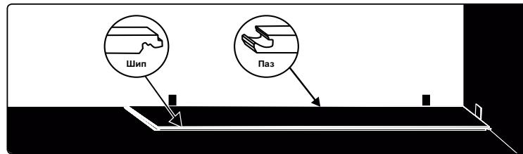
**01** Укладка плитки осуществляется последовательно в выбранном направлении. Обычно начинают с правого угла, если стоять лицом к выбранной стене. Такой способ укладки называется «шип-в-паз»
