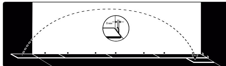
**03** С помощью ножа и угольника отрезать последнюю доску ряда такого размера, чтобы между концом ряда и стеной остался 8 мм зазор. Укладка очередного ряда начинается с остатка плитки предыдущего ряда, при условии, что длина оставшегося фрагмента не менее 1/3 и не более 2/3 длины
