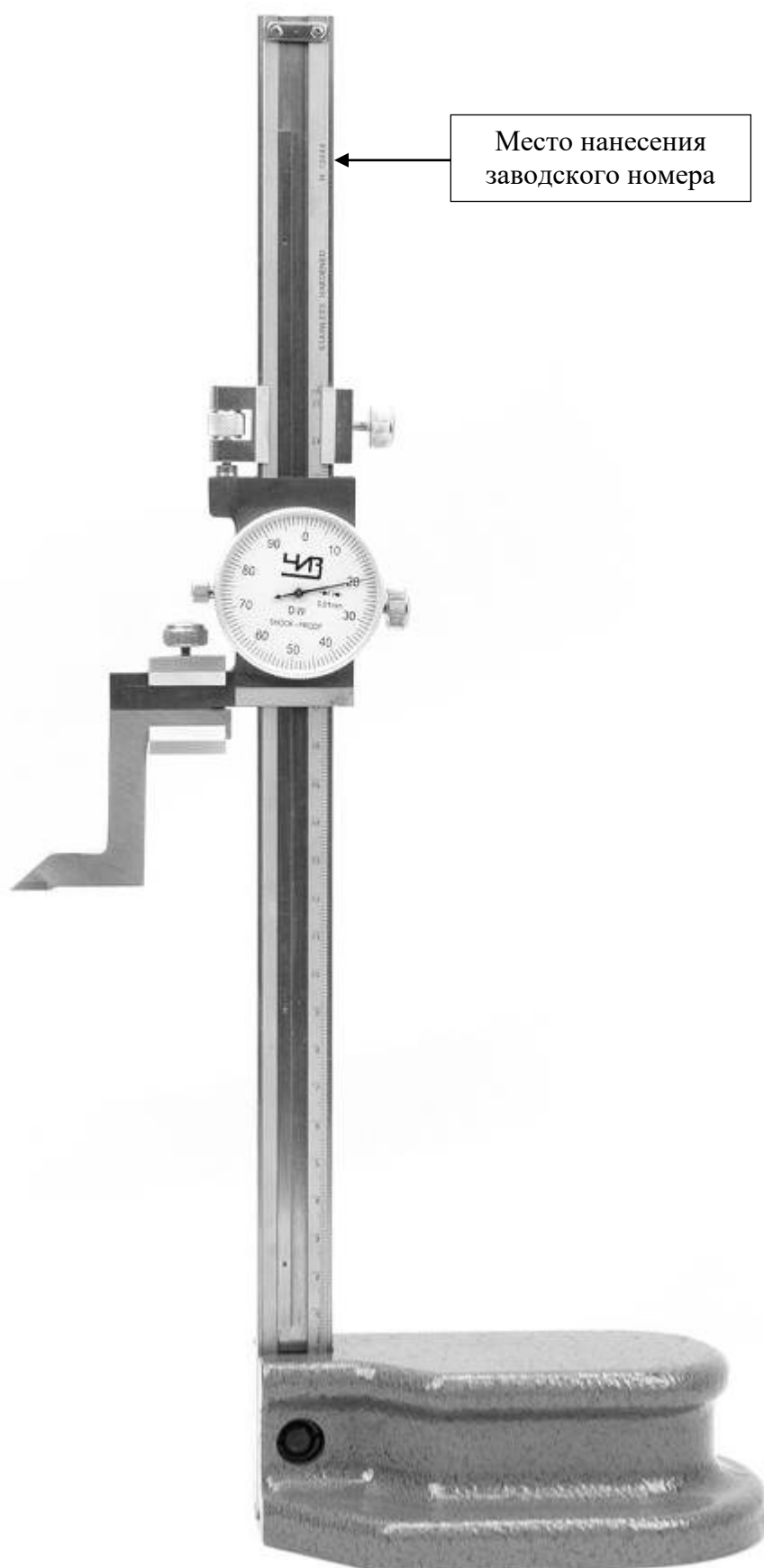
Рисунок 5 – Общий вид штангенрейсмасов модификации ШРК и место нанесения заводского номера
