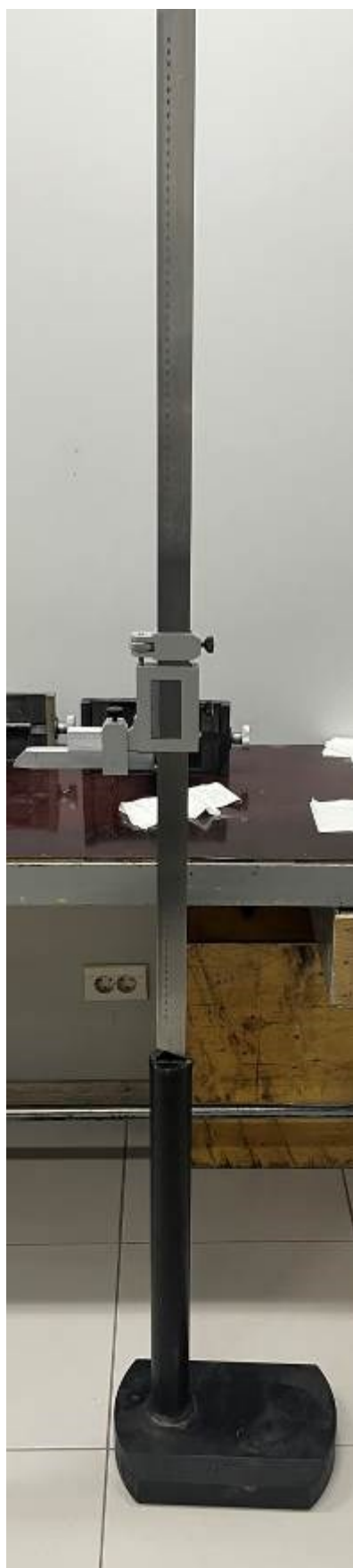
Рисунок 4 – Общий вид штангенрейсмасов модификации ШР
