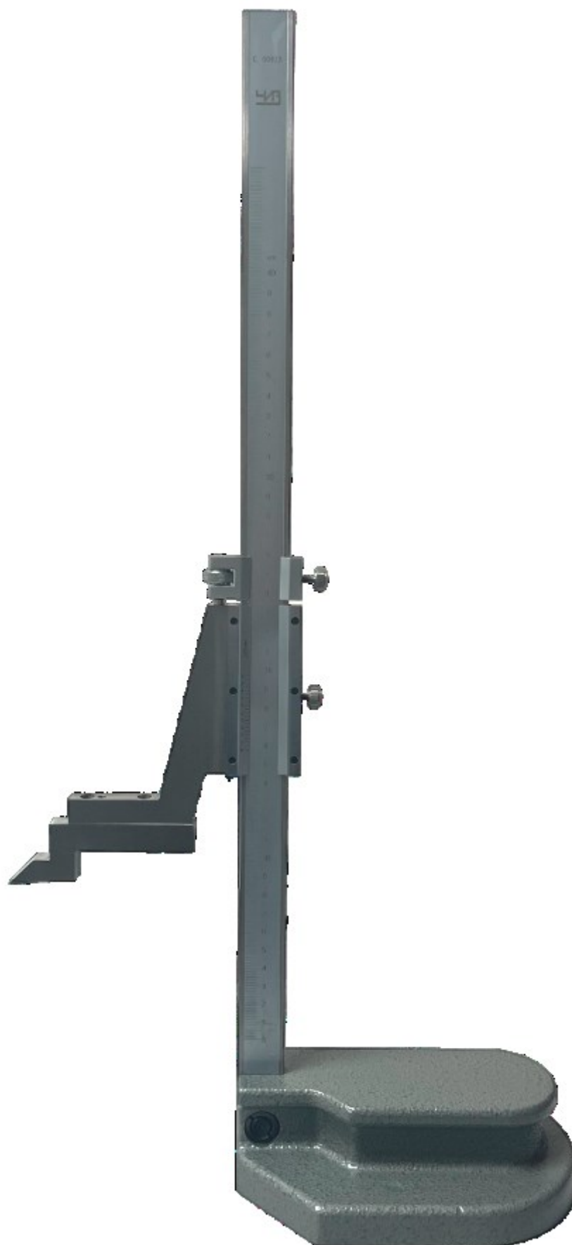
Рисунок 2 – Общий вид штангенрейсмасов модификации ШР
