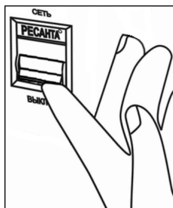
Рис. 4. Включение стабилизатора, проверка входного напряжения
