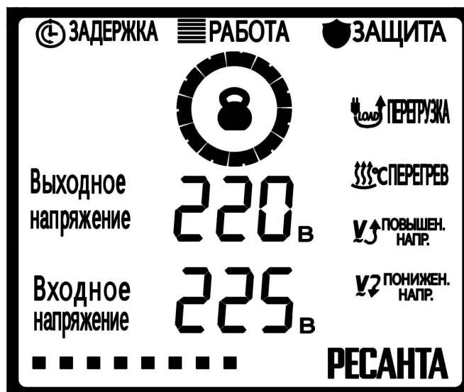
Рис.5. Показания дисплея после подключения нагрузки
