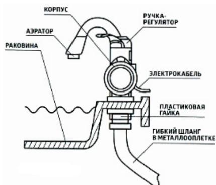
**ВНИМАНИЕ!** Подключение крана к электрической сети можно производить только после его установки в рабочем положении и только после того, как он будет заполнен водой. Несоблюдение данного требования приведет к повреждению крана и лишит владельца права на гарантийный ремонт.
