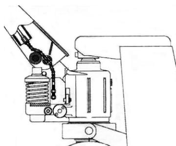
4. Проденьте цепочку рычага управления через отверстие в оси рычага над нажимным роликом
