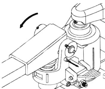
3. Наклоните рычаг так, чтобы скжаслась пружина насоса и извлеките страховочный палец
