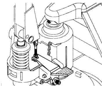
5. Вставьте наконечник цепочки в прорезь уголкового рычага и отрегулируйте гайками цепочки или регулировочным винтом на уголковом рычаге зазор свободного хода уголка в пределах 2-4 мм.
