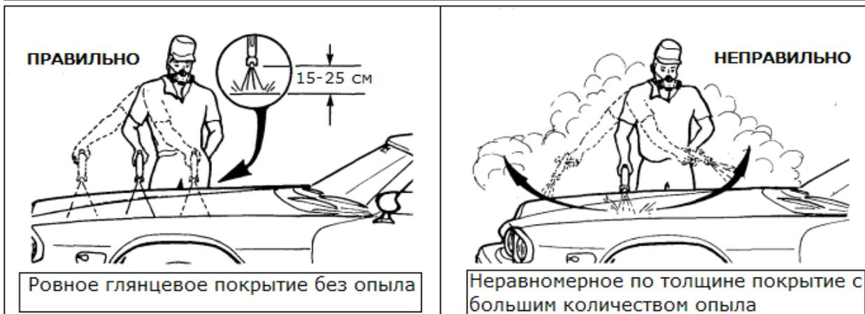
После окрашивания краёв и углов можно приступать к основной поверхности панелей автомобиля.
