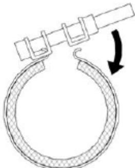
5. Проверьте крепление, убедившись, что хомут надежно зафиксирован и не имеет значительной подвижности.
