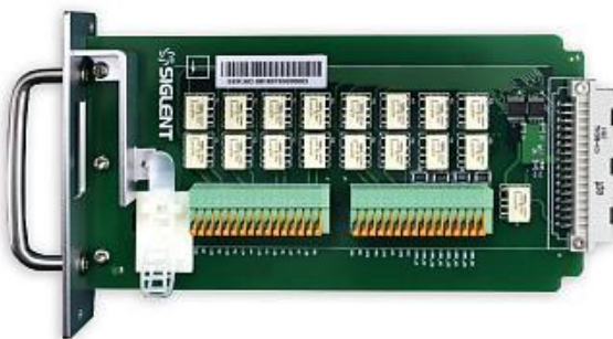
16-канальный сканер для вольтметров АКИП-2101 и АКИП-2101/2
