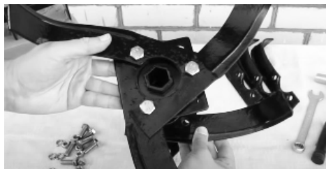
Рис. 3а,б. Крепление лопастей фрезы
