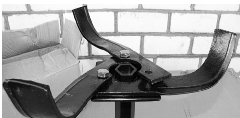
Рис. 3а,б. Крепление лопастей фрезы
