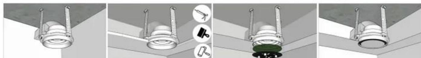
5. Закрепите конструкцию к потолку, соединив решетку с воздуховодом напрямую или через соответствующий вашей системе каналов переходник
