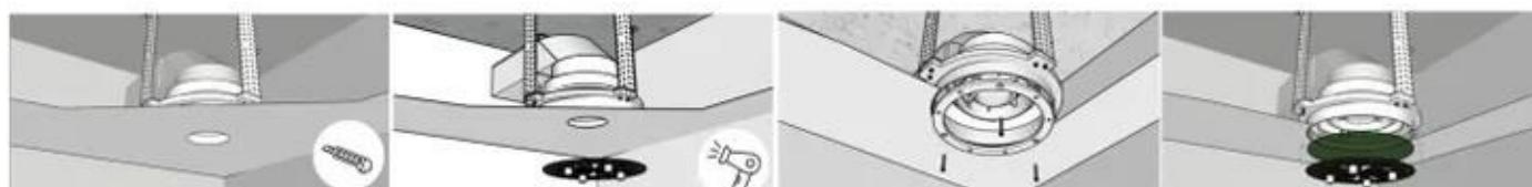
5. Легким нажатием определяем центр решётки и с помощью режущего инструмента, сделайте правильное отверстие, диаметром 60мм
