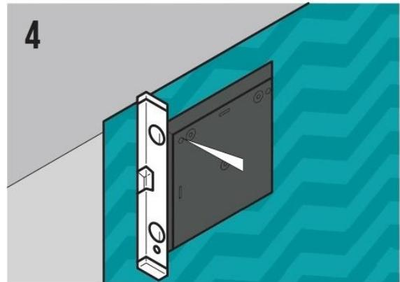
Используйте лапки на корпусе решетки для регулировки лотка бровень с поверхностью.
