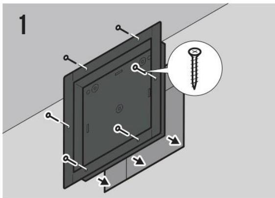
Установите корпус решетки в черновой стене. Закрепите корпус винтами.
