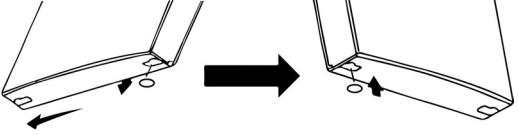
4. Переверните верхний шарнир на 180° (чтобы штифт был направлен вверх) и закрепите на противоположной стороне в нижней части прибора. Установите дверь обратно на нижнюю петлю.
