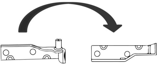
5. Переверните нижнюю петлю на 180° (так, чтобы штифт был направлен вниз), вставьте штифт петли в верхнюю часть двери и зафиксируйте ее на месте. Убедитесь, что дверь выровнена по горизонтали и вертикали, прежде чем окончательно затянуть верхний шарнирный штифт.
