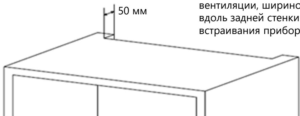
Оставьте пространство для вентиляции, шириной 50 мм. вдоль задней стенки шкафчика для встраивания прибора.
