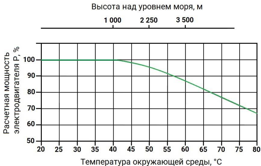
Рисунок 2 – Зависимость мощности электродвигателя от температуры окружающей среды и высоты над уровнем моря
