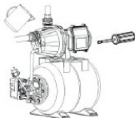
Снимите крышку (1) и с помощью автомобильного манометра измерьте давление в пневмоклапане (2). Убедитесь, что давление равно 1,4-1,5 атм. В случае недостаточного давления необходимо его повысить при помощи обыкновенного насоса для подкачки шин, путем подключения шланга для подкачки к пневмоклапану (2) на задней стороне гидробака.
