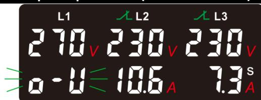
Текущее значение напряжения отображаются на верхних экранах L1-L2-L3, при этом код ошибки по перенапряжению мигает на нижнем экране фазы где произошел сбой.
