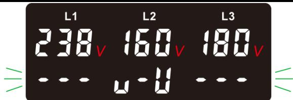
Текущее значение напряжения отображаются на верхних экранах L1-L2-L3, при этом код ошибки по перенапряжению мигает синхронно на нижних экранах L1-L2-L3.
