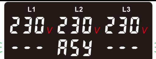
Текущее значение напряжения отображаются на верхних экранах L1-L2-L3, при этом код ошибки по асимметрии мигает на нижнем экране L2 во время отсчета задержки сброса. После отсчета выходные реле замкнутся
