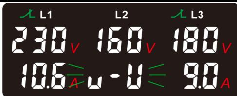
Текущее значение напряжения отображаются на верхних экранах L1-L2-L3, при этом код ошибки по перенапряжению мигает на нижнем экране фазы где произошел сбой.
