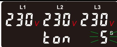
Текущее значение напряжения отображаются на верхних экранах L1-L2-L3, при этом отсчет задержки до замыкания выходных контактов реле мигает на нижнем экране L3.
