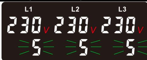
Текущее значение напряжения отображаются на верхних экранах L1-L2-L3, при этом отсчет задержки до замыкания выходных контактов реле мигает на нижних экранах L1-L2-L3.
