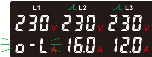
Текущее значение напряжения отображаются на верхних экранах L1-L2-L3, при этом код ошибки по перегрузке мигает на нижнем экране фазы где произошел сбой.
