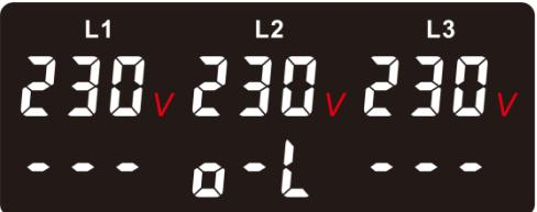
Текущее значение напряжения отображаются на верхних экранах L1-L2-L3, при этом код ошибки по перегрузке мигает синхронно на нижних экранах L1-L2-L3.
