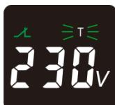
Отображение рабочего напряжения во время отсчёта задержки пуска/повторного включения.
