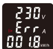
После нескольких повторных включений устройства из-за перегрузки по току
