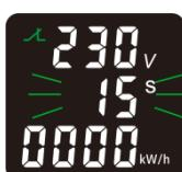
Отображение рабочего напряжения и временной задержки во время отсчёта задержки пуска/повторного включения.
